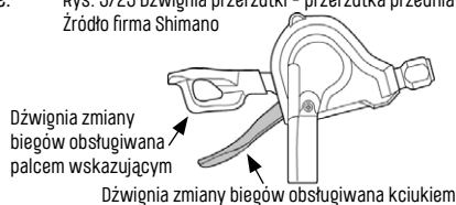
Rys. 3/23 Dźwignia przerzutki - przerzutka przednia Źródło firma Shimano
