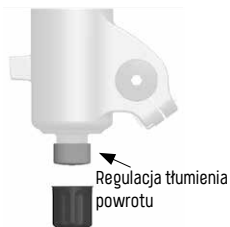
Rys. 2/47 Tłumienie powrotu źródło: Fox
